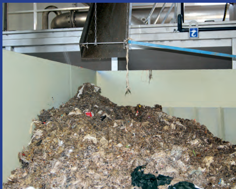
Lingettes récupérées à la station d'épuration de Morteau
