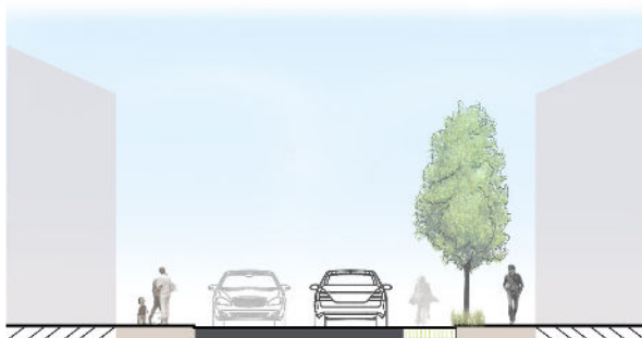
Configuration 1 : Emprise \approx 10m, circulation en double sens bande cyclable unidirectionnelle, trottoirs bilatéraux.
