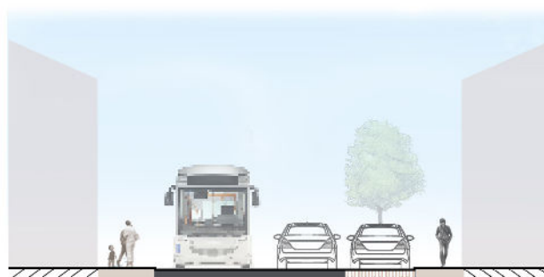
Configuration 3 : Emprise \approx 12 m, circulation en double sens (avec passage de bus), sans aménagement cyclable, trottoirs bilatéraux, stationnement unilatéral.
